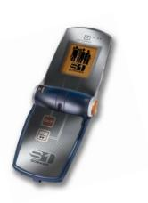
**Ortovox 3+** LVS-Gerät erhöht die Sicherheit des Benutzers durch das Smart Antenna Prinzip, welches automatisch auf die beste Sendeantenne umschaltet und durch intelligente Lageerkennung den Signalempfang deutlich beschleunigt. Damit gibt es keine schlechteste Lage des Verschütteten mehr.
